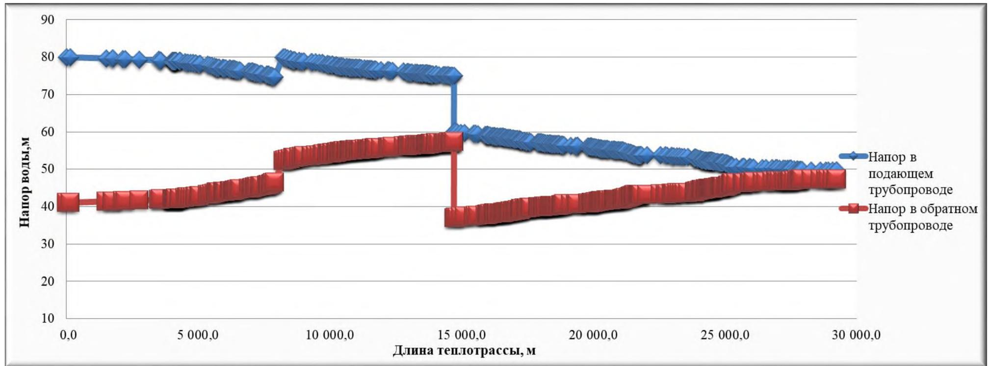
Рисунок 2.1 – Пьезометрический график тепловой сети котельной «Центральная» по магистральному выводу
