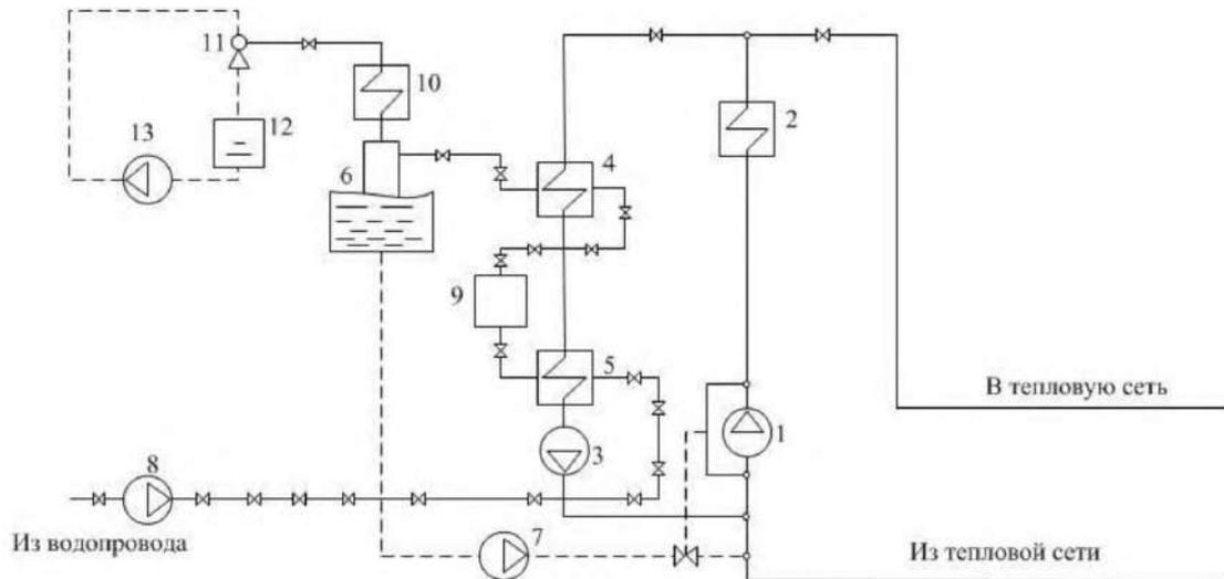
Рисунок 2.1 – Тепловая схема котельной с водогрейными котлами:
