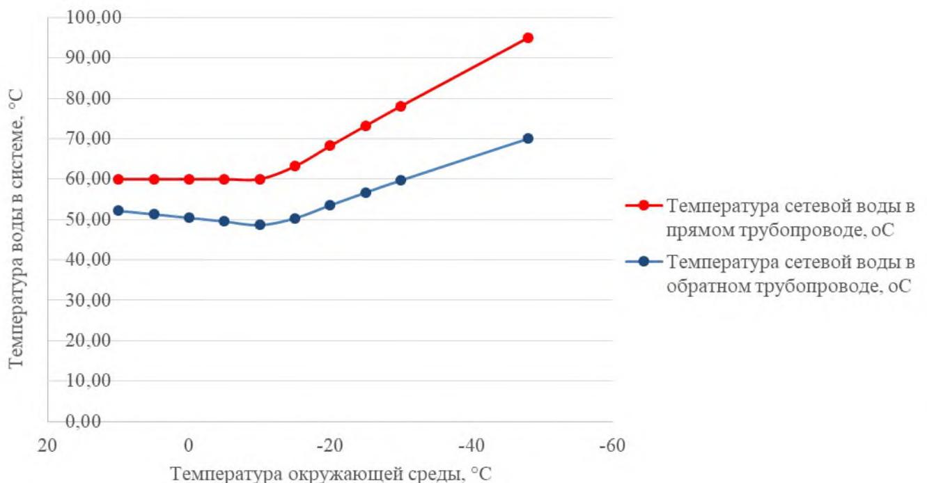
Рисунок 2.3 – График изменения температур теплоносителя (температурный график  $95/70^{\circ}\text{C}$ )
