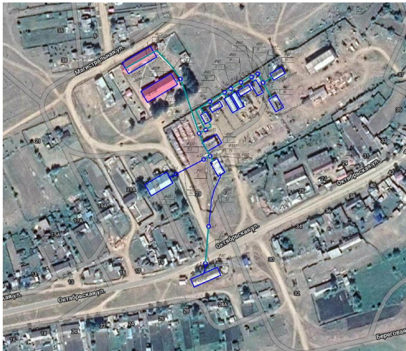
Рисунок 1.3.2.1. Принципиальная схема теплоснабжения Заледеевского сельсовета котельная «Поселковая»
