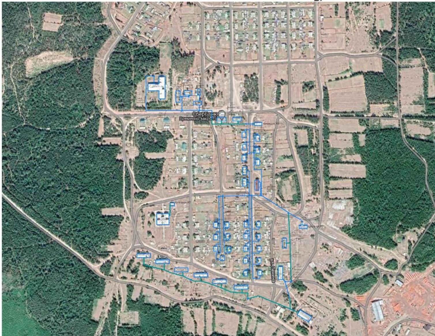
Рисунок 1.3.2.1. Принципиальная схема теплоснабжения Недокурского сельсовета котельных
