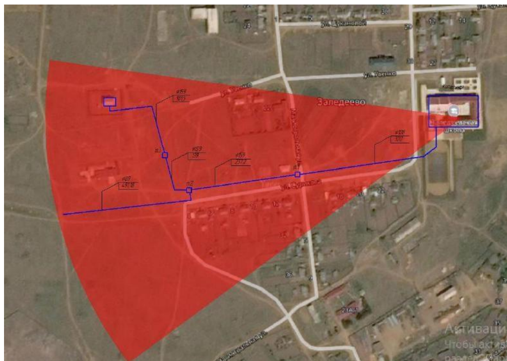
Рисунок 7.15.2. Радиус теплоснабжения котельной «Школа» с. Заледеево
