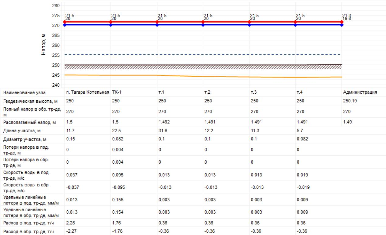
*Рисунок 1.3.8.1. Пьезометрический график от котельной «д. Тагара, ул. ул.Школьная,16» до потребителя «Администрация»*
