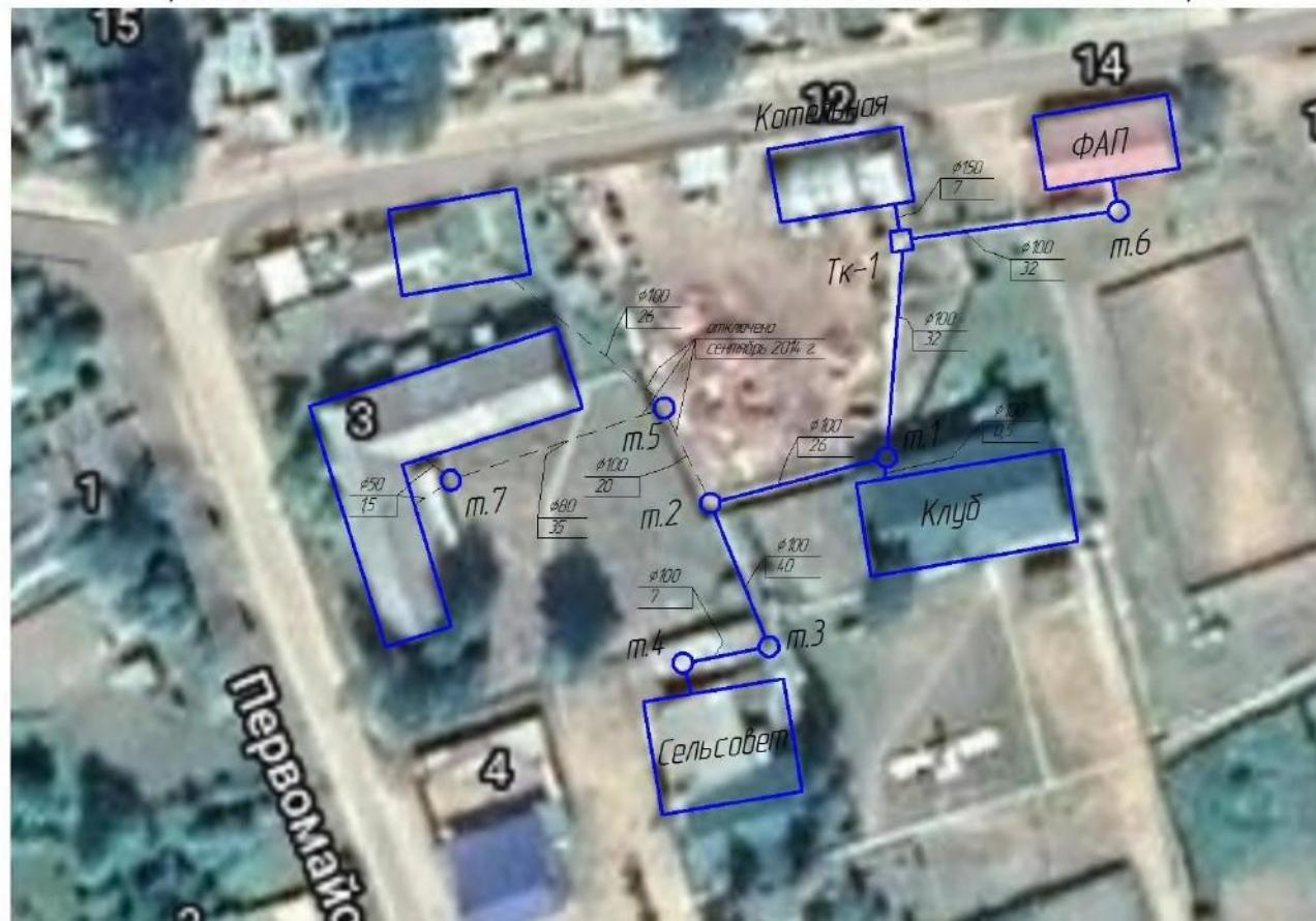
Рисунок 1.3.2.1. Принципиальная схема теплоснабжения Тагарского сельсовета
