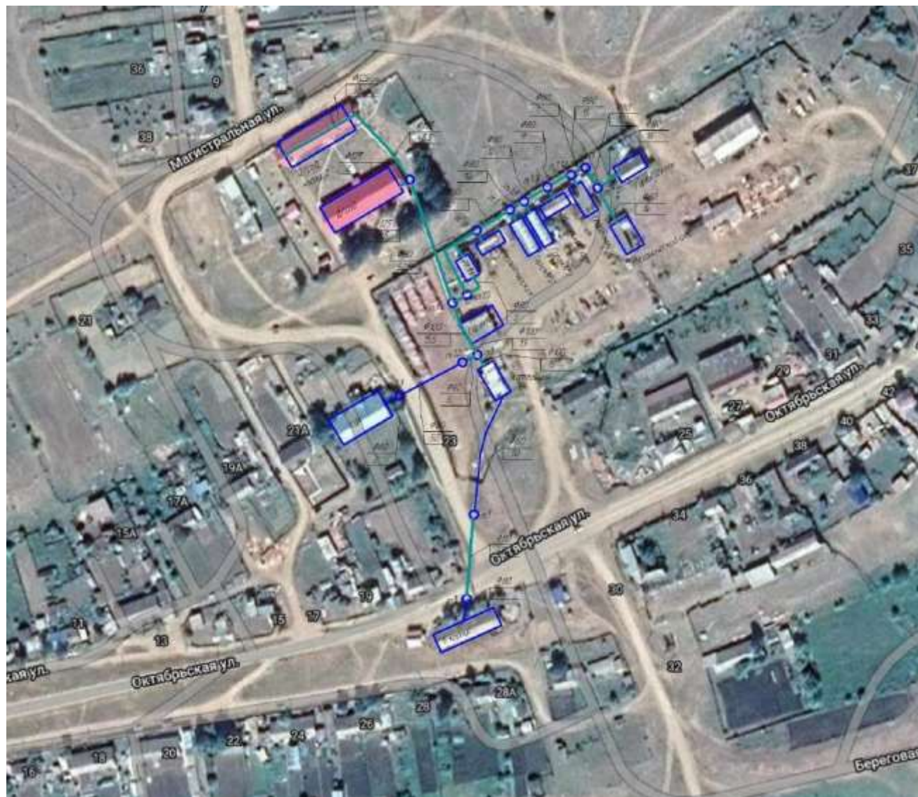
Рисунок 4. Принципиальная схема теплоснабжения Заледеевского сельсовета, котельная «Поселковая»
