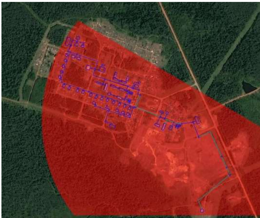
Рисунок 7.15.1. Радиус теплоснабжения котельной «Поселковая» п. Имбинский
