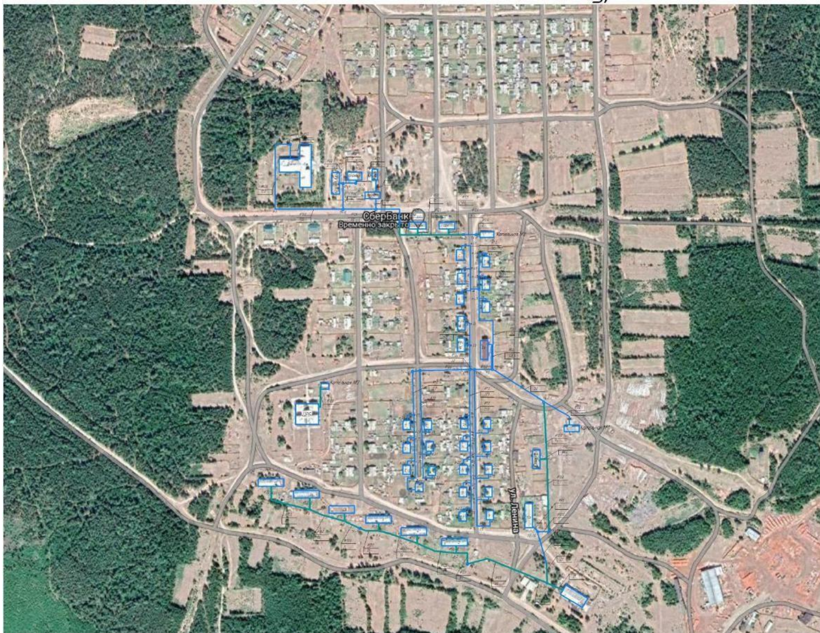
Рисунок 6. Принципиальная схема теплоснабжения Недокурского сельсовета котельных
