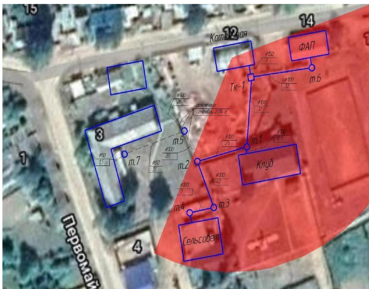
Рисунок 7. Радиус теплоснабжения котельной «д. Тагара, ул.Школьная,16»
